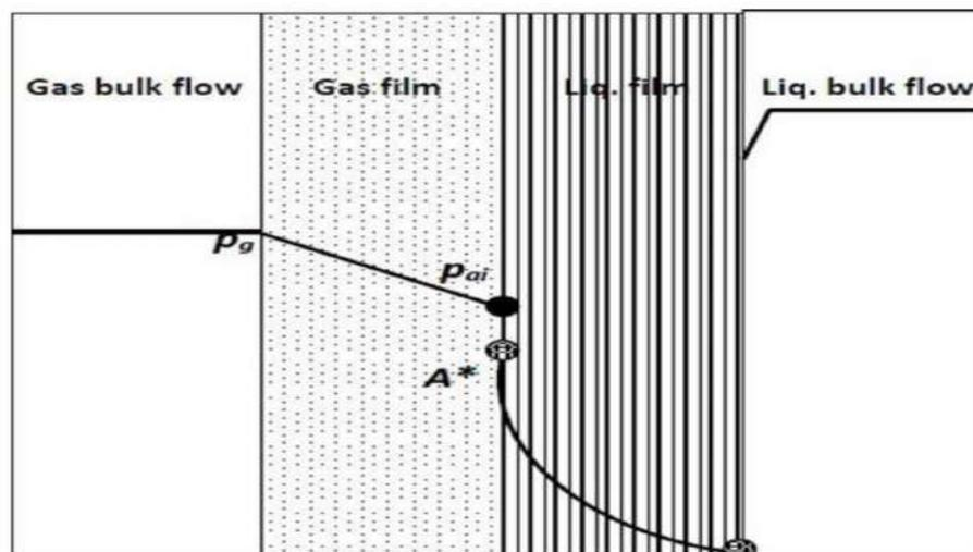
Gambar 2.2 Mekanisme absorpsi gas CO<sub>2</sub> dalam larutan NaOH
